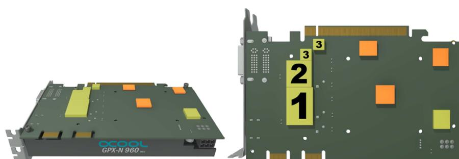
Entfernen Sie die Schutzfolie der orange dargestellten 15mm x 15mm x 2mm Wärmeleitpad's und legen diese auf die Speicherbausteine. Schneiden Sie die gelb dargestellten Wärmeleitpad's für die Rückseite, wie im Bild zu sehen ist. Diese werden auf die Rückseite der Spannungswandler und der GPU gelegt. Vergessen Sie auch hier nicht die Schutzfolie zu entfernen.
