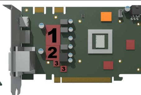
Entfernen Sie die Schutzfolie der rot dargestellten 15mm x 15mm x 2mm-Wärmeleitpad's und legen diese auf die Speicherbausteine. Die orange dargestellten 30mm x 30mm x 2mm Wärmeleitpad's für die Spannungswandler müssen zugeschnitten werden. Vergessen Sie auch hier nicht die Schutzfolie zu entfernen.
