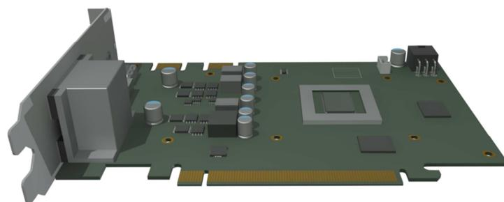
Montage: Legen Sie die Hardware auf eine antistatische Unterlage. Beginnen Sie mit der Demontage des Original-Kühlers. Je nach Aufbau des Kühlers sind zuerst die Schrauben des Lüfters zu entfernen und die Blenden zu lösen. Bei aufgeklebten Kühlern ist äußerste Sorgfalt geboten. Es können leicht Bauteile abgerissen werden. Heben Sie alle Einzelteile sorgfältig auf. Reinigen Sie anschließend die Hardware von Resten der Wärmeleitpaste oder Pad's mit einem Lösemittel (z.B. Spiritus).
