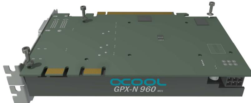
Schrauben Sie die Schrauben mit den Unterlegscheiben wie im Bild zu sehen ein. Ziehen Sie die Schrauben aber noch nicht fest an.
