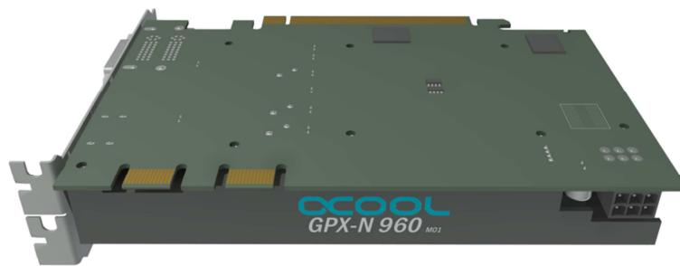
Montieren Sie nun den zusammen gebauten Kühler auf die Grafikkarte wie im Bild zu sehen. Falls eine Schutzfolie auf dem Kühlerboden vorhanden ist, entfernen Sie bitte jetzt die Schutzfolie. Reinigen Sie die Kontaktflächen auf der Bodenseite des Kühlers mit Spiritus oder ähnlichen Mitteln. Die Fläche muss frei von Verunreinigungen sein.
