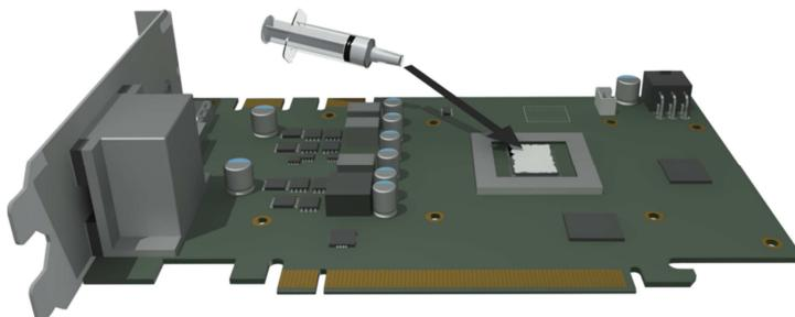
Tragen Sie nun unter Zuhilfenahme eines Plastikstreifens oder ähnlichem, eine gleichmäßige Schicht Wärmeleitpaste auf die zu kühlenden GPU auf. Die Schicht sollte weniger als einen Millimeter dick sein, da sonst die umliegenden Bauteile unnötig verunreinigt werden können.
